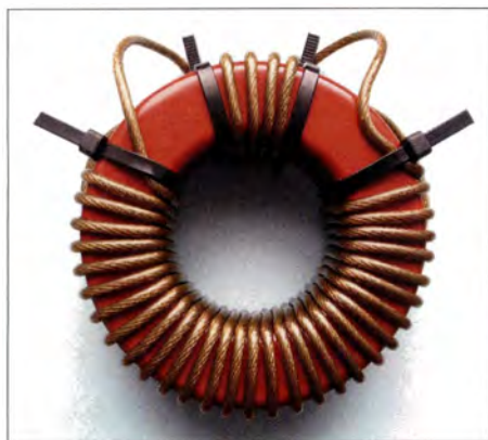
Bild 4: Details zur Wickeltechnik der Sekundärkreisspule und der Linkspule auf einem Amidon-Ringkern T400A-2
