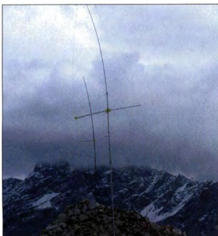
Bild 3: 15-m-VDA und 12-m-VDA im Sturm
