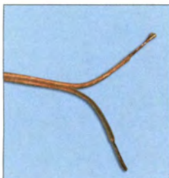
Bild 5: Als Antennendraht kommt hier isolierte Zwillingskupferlitze zum Einsatz, deren Einzeladern vorher zu trennen sind.
