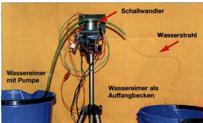
Bild 1: Probeaufbau, der Körperschallwandler auf dem Stativ formt den ansonsten nahezu gerade austretenden Wasserstrahl durch Bewegung des freien Schlauchendes zu einer Spirale um.
