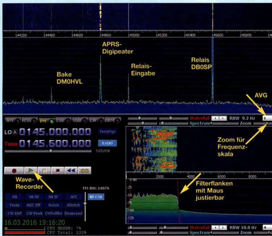
Bild 31: Das ganze 2-m-Band zeigt HSDR auf einen Blick, hier beidseitig abgeschnitten; links die Knopfreihe für die Sendarten, darunter Mittenfrequenz der Anzeige, darunter tatsächliche Empfangsfrequenz; unter dem Wave-Recorderfeld weitere Einstellmöglichkeiten, die bei Aktivierung hell aufleuchten und jeweils per Mouse-Over-Effekt erklärt werden.
