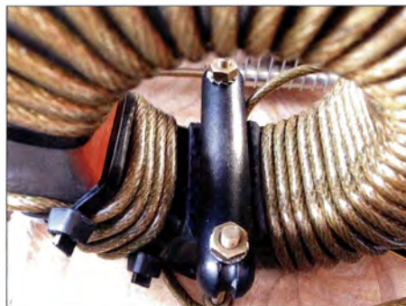
Bild 5: Die Ringkernspule wird stehend auf dem Holzbrett befestigt. Die Linkspule befindet sich unten links. Fotos: DF2BC
