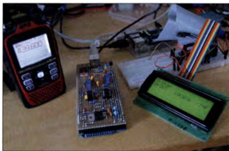
MMDVM-Testaufbau bei DF2ET mit GM1200, Arduino und D-STAR-Baugruppe (v.l.n.r) Foto: DF2ET
