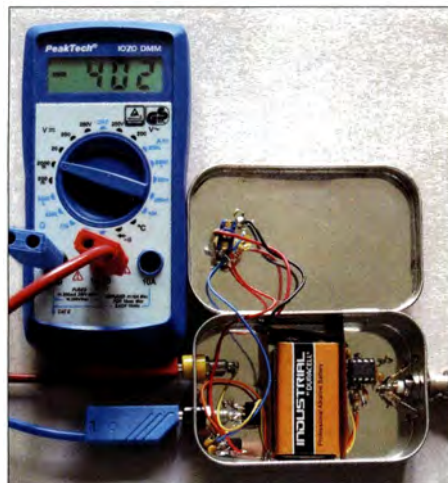
Bild 1: Der HF-Leistungsmessvorsatz zum Multimeter ist in freier Verdrahtung ausgeführt und in einer kleinen Blechschachtel untergebracht; hier werden -40,2 dBm angezeigt.
