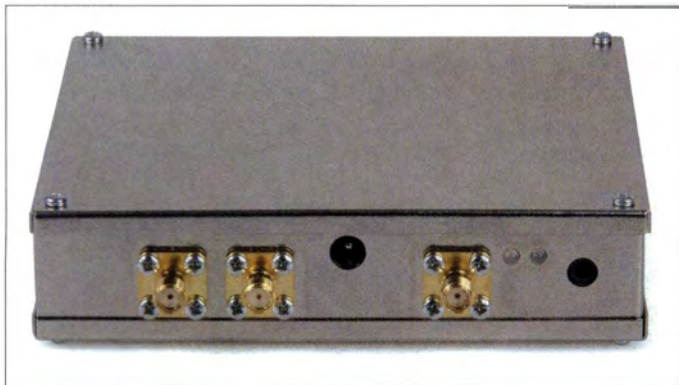
Bild 1: Gesamtansicht des Transverters; v. l. n. r. Buchse für gemeinsame Antenne bzw. Sendesignal, ggf. nutzbare separate Empfangsantennenbuchse, Stromversorgungsbuchse, ZF-Buchse, Mehrfarb-LED für Eingangssignal, Mehrfarb-LED für Ausgangssignal, Klinkenbuchse für PTT und Sequenzer
